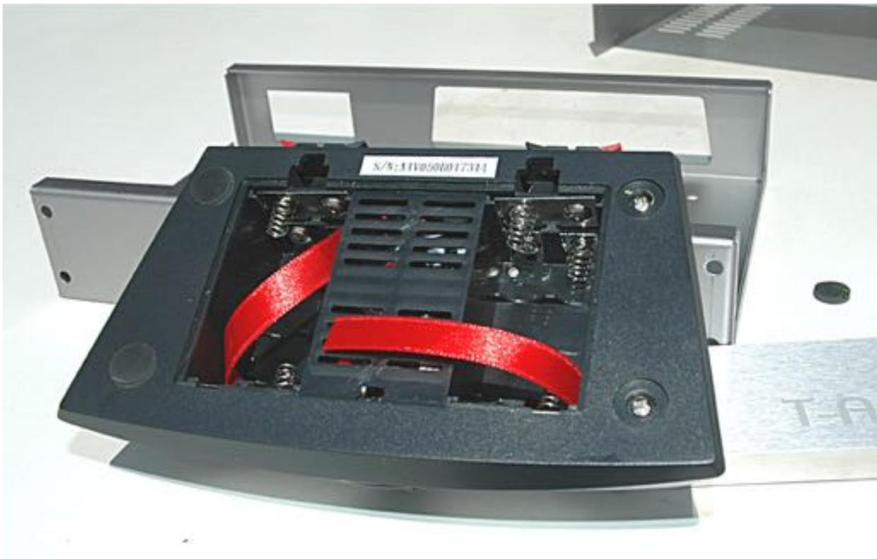
Per aprire il contenitore plastico del T-AMP bisogna svitare 6 viti, 4 sotto i piedini autoadesivi e 2 piccole viti all'interno del vano batterie (attenzione necessitano 2 cacciaviti differenti in quanto le 2 viti interne sono molto piccole)
