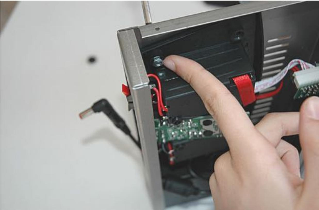
Passare al fissaggio della base plastica del T-AMP utilizzando solo i 2 fori vicini alla parete posteriore
