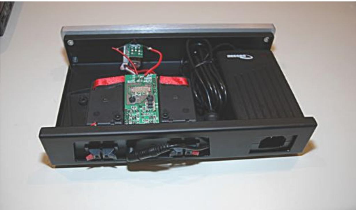
Ecco come si presenta il T-AMP con l'alimentatore montato all'interno del nostro contenitore
