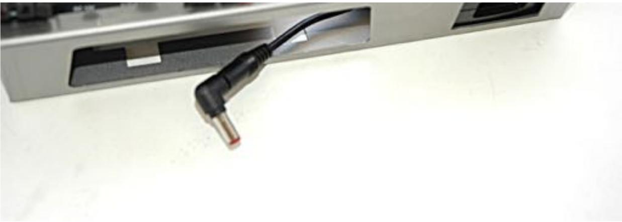
Sistemare un alimentatore non fornito (abbiamo usato il PD266 da 4 Amp. Della Accord) avendo cura di fare uscire il terminale come indicato
