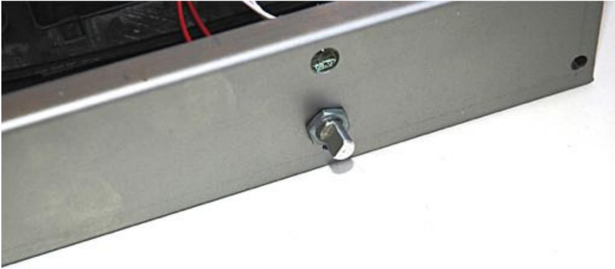
Fissare il potenziometro con il dado piccolo smontato precedentemente
