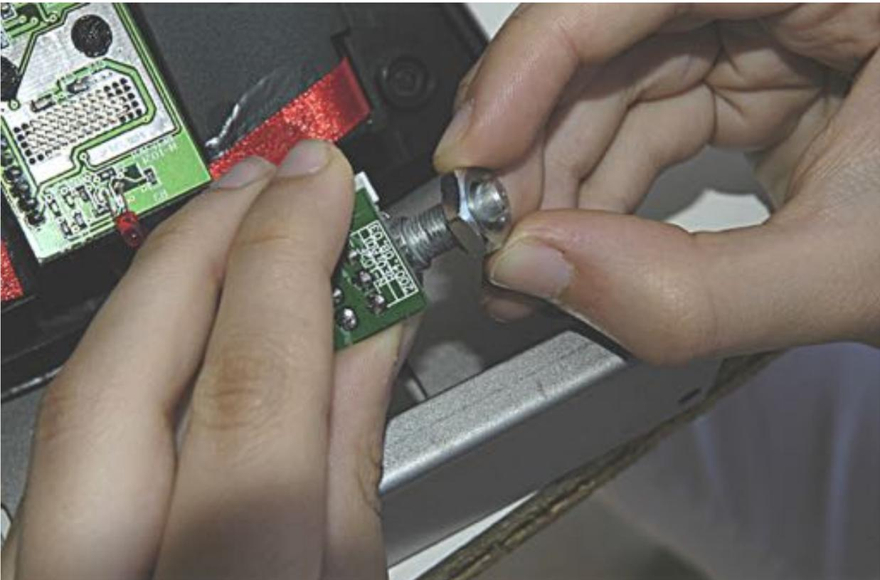
Utilizzare il distanziatore esagonale fornito in dotazione con le viterie del contenitore.
